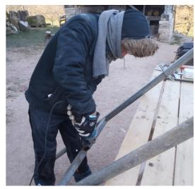
Nous sommes en train de fabriquer un nouveau modèle de « rocket stove » pour le week-end des métiers d'art qui se déroulera à Brancion. Les matériaux nécessaires pour la fabrication de ce nouveau modèle sont : 1 cocotte minute, 2 bouteilles de gaz, 1 tube carré de 100mm, 3 autres tubes de 90mm, 3 tubes rectangulaires, 3 platines. En parallèle, nous réparons notre premier rocket stove dont la chambre de combustion s'est percée à l'usage. De nouvelles plaques sont soudées en remplacement.
