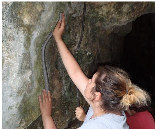
Nous avons reporté les bandes de plomb courbées sur des barres de fer de faible section 10x10 mm en les travaillant à l'aide de griffes (genre de clés servant à couder ou à torsader des barres de métal pleines), reproduisant la forme des parois sur ce nouveau gabarit.
