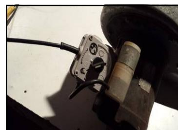
La puissance du souffle transformant la forge en tuyère, il nous faut adapter un système de régulation du débit d'air. Nous traçons et découpons une tôle pour le régler puis perçons pour adapter un raccord de la turbine vers le foyer de forge. Pour cette adaptation, il nous faut confectionner un cône assemblé à la soudure à l'arc, nous nous servons du marteau et de l'enclume pour adapter ce cerclage. Nous réalisons ensuite des tests qui s'avèrent concluants.
